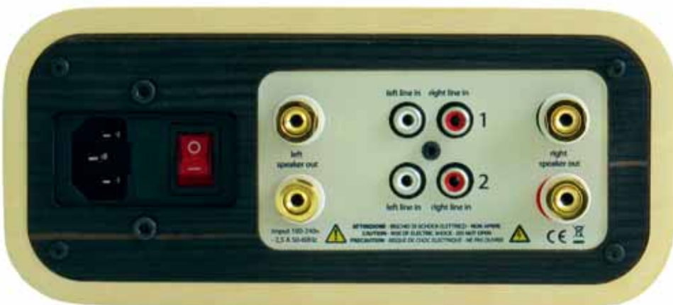
In primo piano il pannello posteriore dell'amplificatore con gli ingressi 2x sbilanciati, la vaschetta IEC, l'interruttore di accensione ed i binding post simili a quelli delle Nika.
