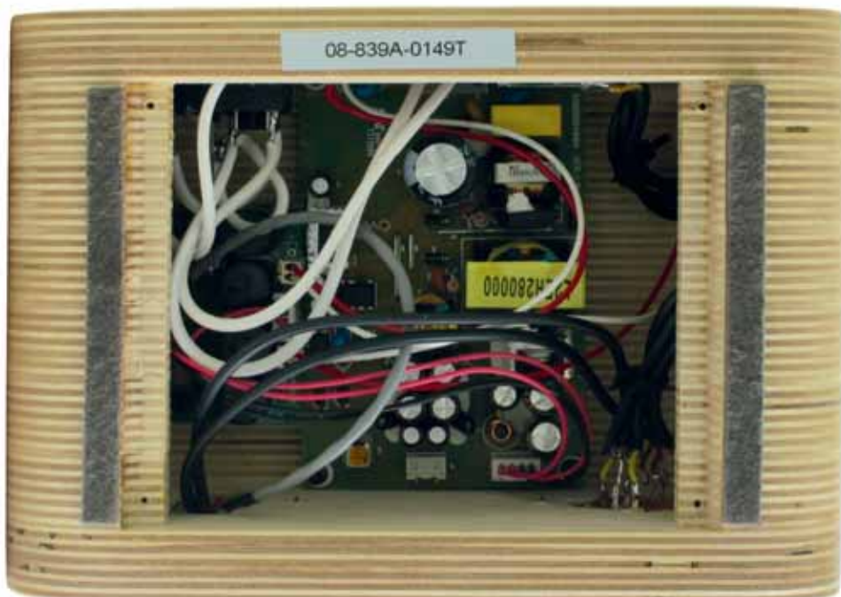
Interno dell'amplificatore, l'alimentazione switching e la sezione di amplificazione digitale.
