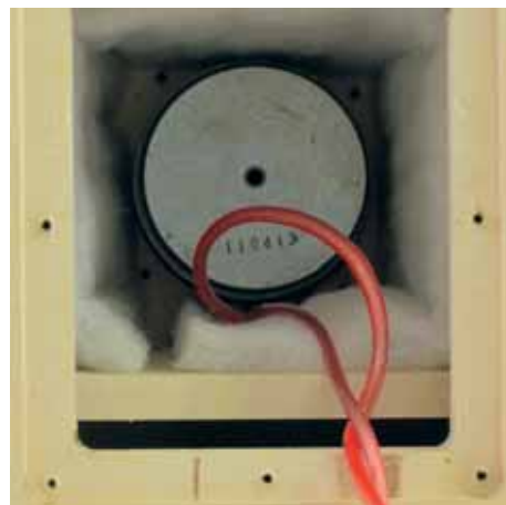
L'interno del diffusore rivestito di assorbente acustico.
